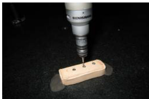
شکل ۳: دستگاه CMM برای اندازه‌گیری نمونه‌ها در سه بُعد
