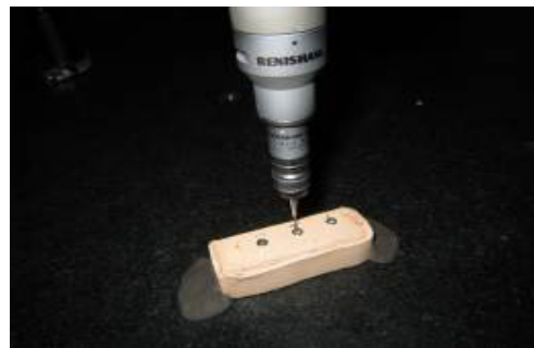
شکل ۳: دستگاه CMM برای اندازه‌گیری نمونه‌ها در سه بُعد
