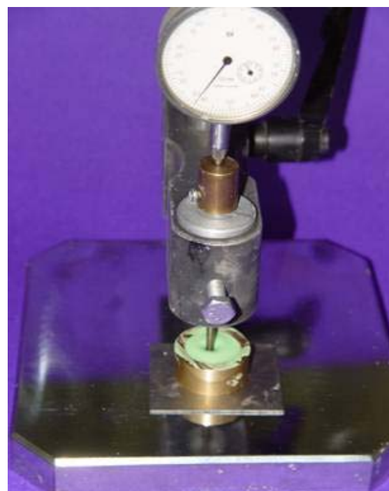
شکل ۱: وسیله مورد استفاده در تعیین زمان کار و نمونه مورد نظر
