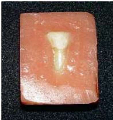
شکل ۱: ایجاد سطح مینائی مسطح و پالایش شده به قطر حداقل پنج میلی‌متر
