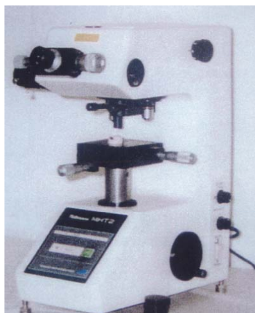
شکل ۳: دستگاه میکروسختی سنجی ویکرز با نام Matsuzawa و مدل MHT2
