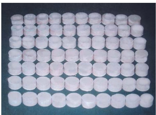
شکل ۲: هفتاد عدد دای ساخته شده جهت آزمایش سختی سنجی
