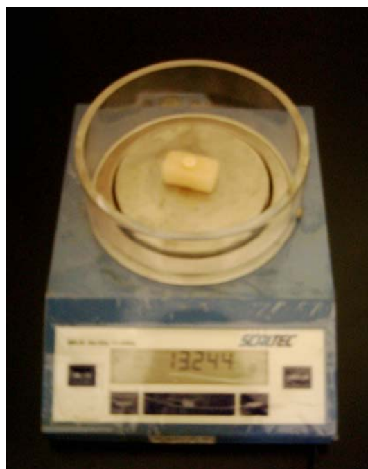
شکل ۲: ترازوی دیجیتالی در حال توزین نمونه دندان
