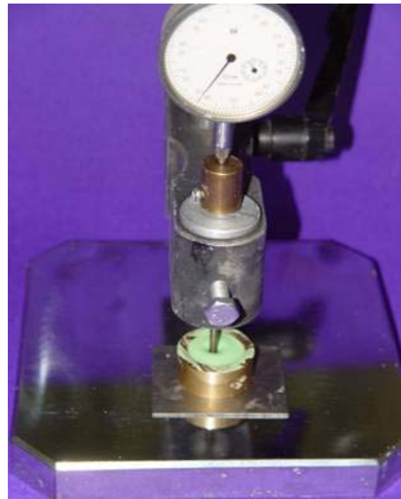
شکل ۱: وسیله مورد استفاده در تعیین زمان کار و نمونه مورد نظر
