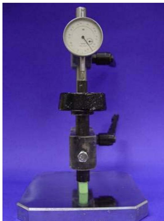
شکل ۳: وسیله مورد استفاده در تعیین تغییر شکل در اثر فشار و نمونه مورد نظر
