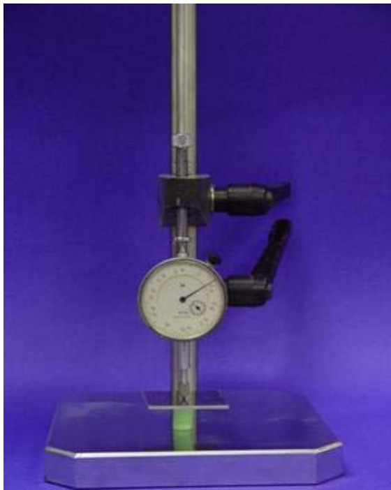
شکل ۲: وسیله مورد استفاده در تعیین تغییر شکل دائمی و نمونه مورد نظر
